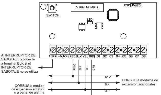
**01 a 08** - Conecte el cable positivo del dispositivo a la terminal AUX; y el cable negativo, a la terminal de salida requerida (O1 a O8). Los siguientes son ejemplos de cómo conectar varios dispositivos a las salidas:
